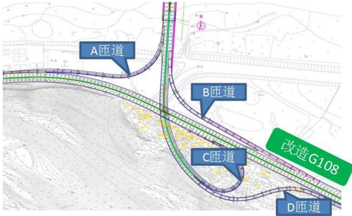
图 1-7 项目与改造 G108 喇叭立交设计示意图
