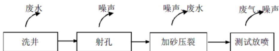
图 5.2-3 完井作业阶段作业流程及产污节点
