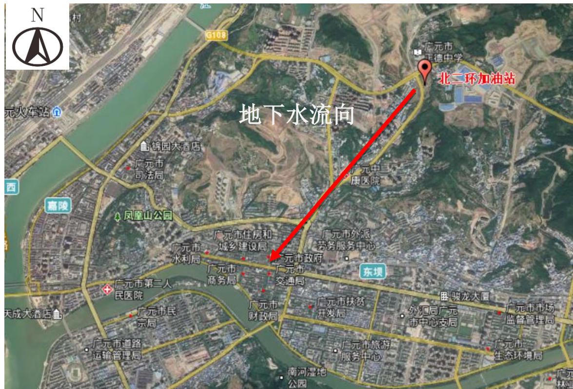
图 3-1 本项目地下水流向示意图
