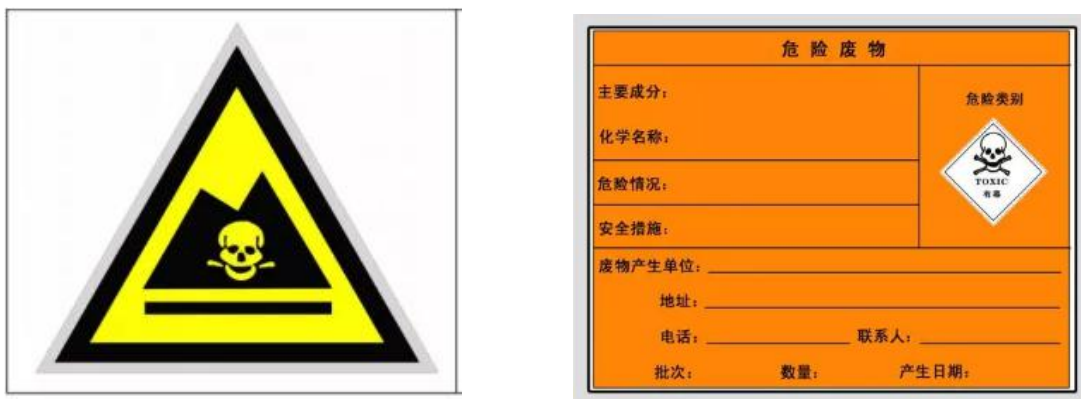
图 5-3 危废暂存间标识
