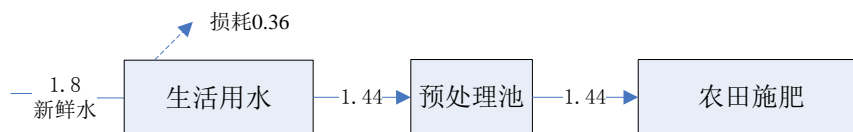
图5-5 项目生活用水水平衡图（单位t/d）
