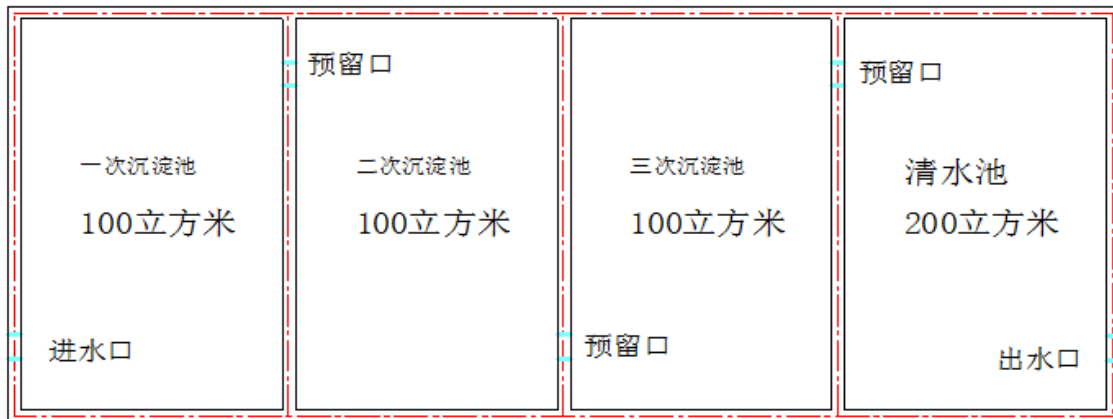
图5-7 沉淀池工艺流程图
