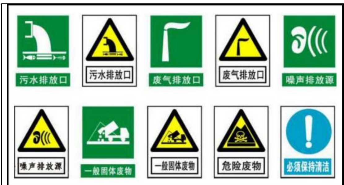
图 7-1 排污口图形标志示例
