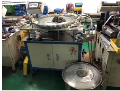
装配车间注液工序
