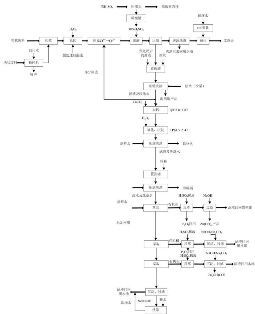
项目重金属回收工艺流程及产污流程
