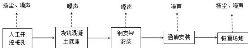
图 2-1 地上廊道工艺流程及排污节点图
