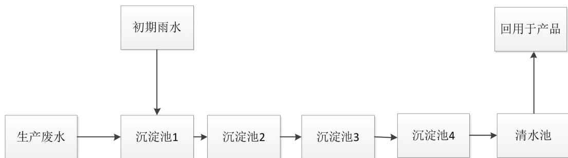
图 4-1 废水处理系统处理工艺流程示意图
