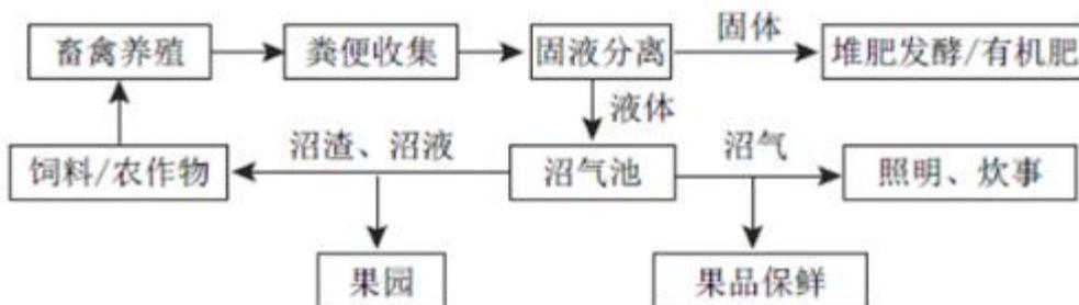
图 3.4-3 沼气工程处理图
