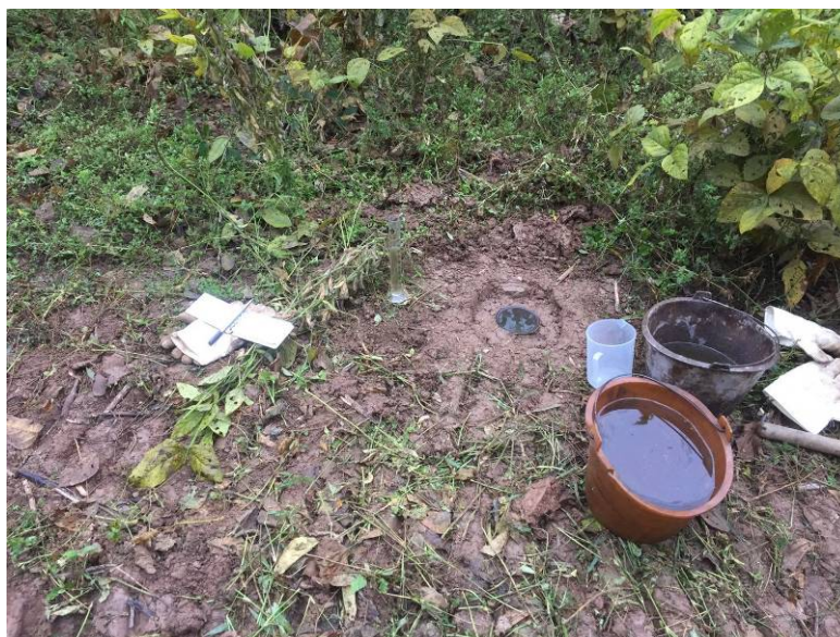
图 3.1-5 现场包气带渗水实验照片
