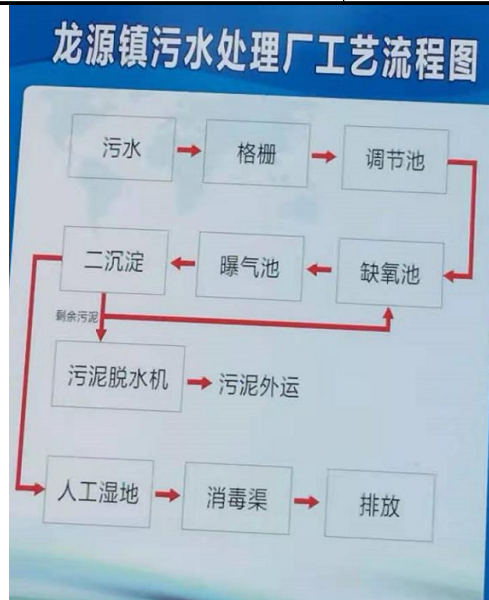
图 4-1 龙源镇污水处理厂工艺流程图
