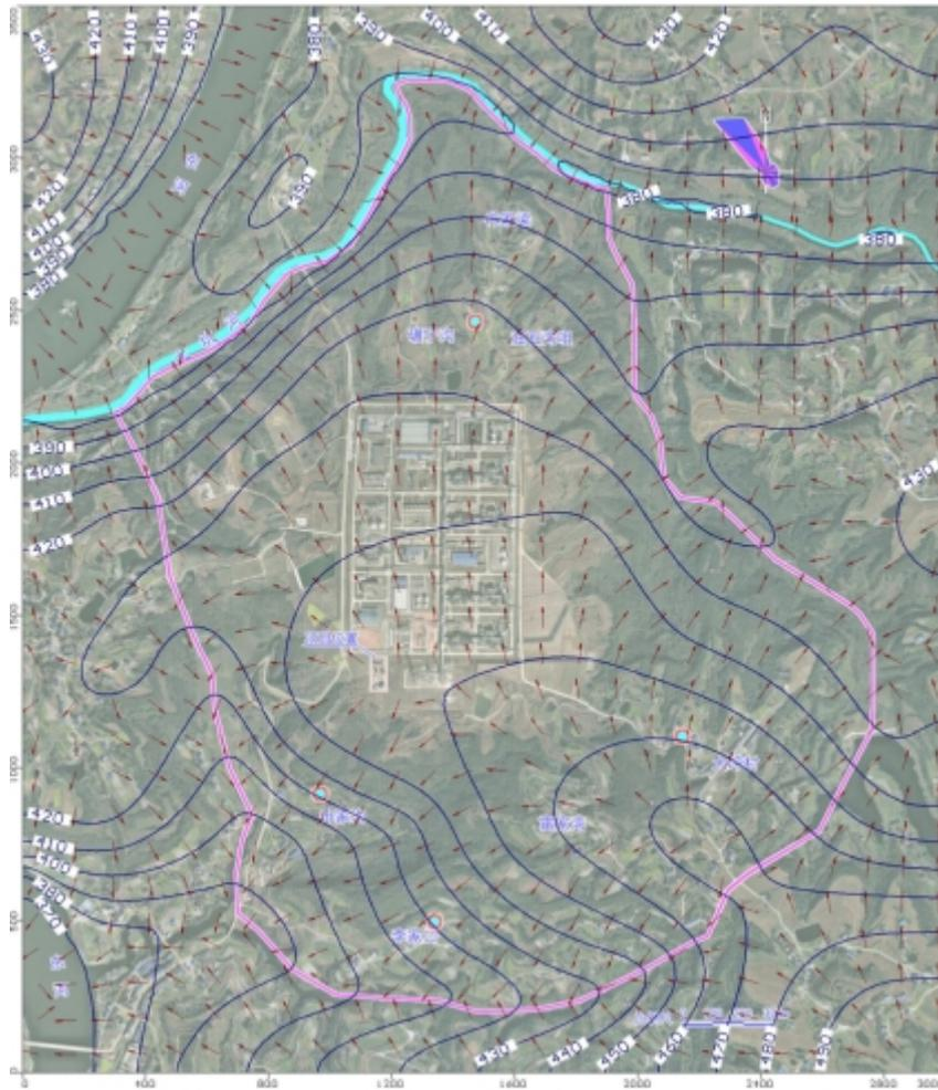
图 7.3-10 大坪污水站模拟区地下水等水位线和流场示意图（单位：m）
