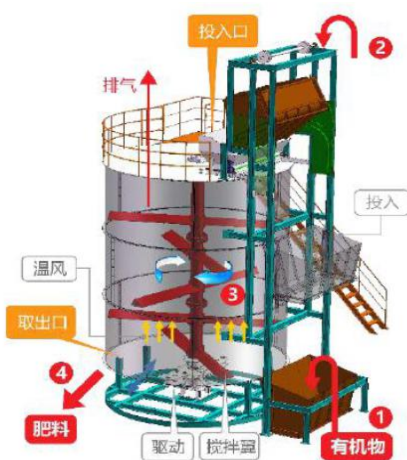
图 3.3-4 智能好氧发酵罐运行原理图
