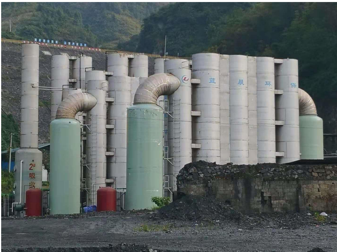
图 9.2-2 重庆武陵锰业有限公司 1000m 3 /d 氨氮吹脱塔（全密闭系统）
