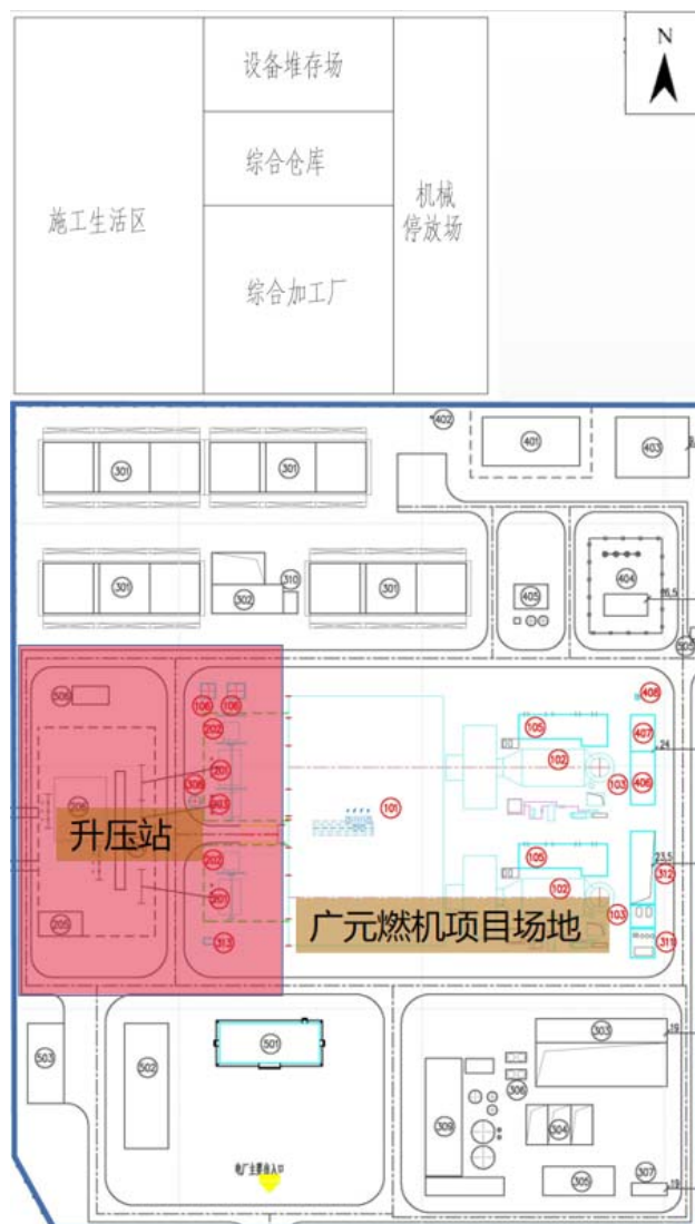
图3 燃机项目施工布置图
