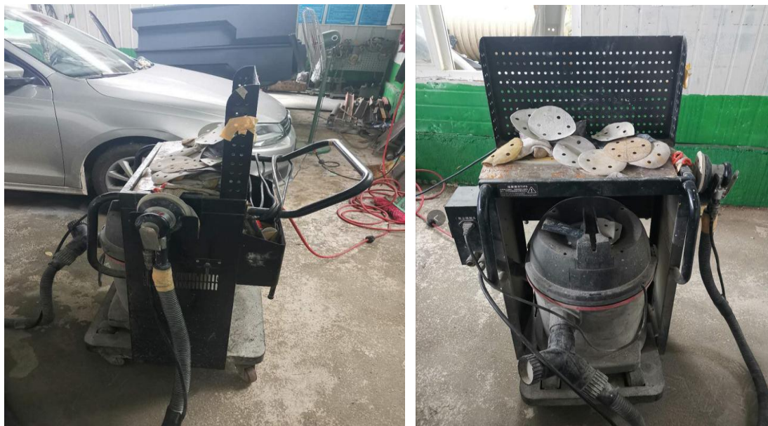
图 5-4 项目打磨粉尘收集净化装置
