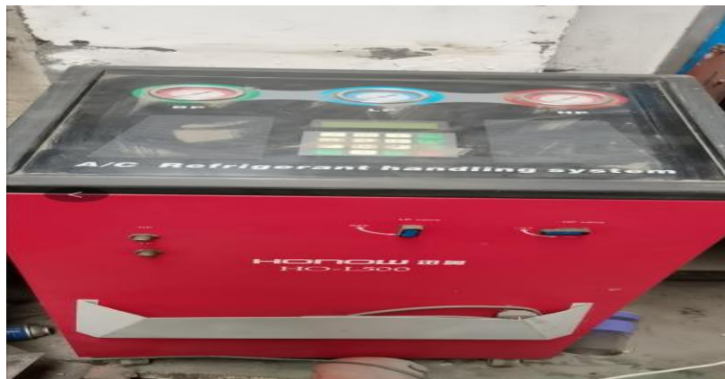
图5-9 项目废制冷剂回收仪
