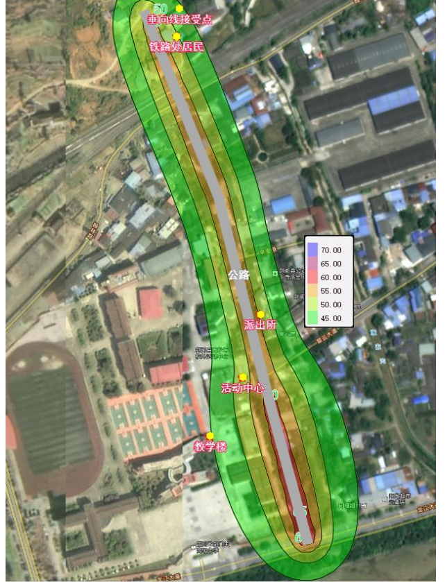
学士街上跨宝成铁路涉铁工程营运期远期夜间等声 值线图
