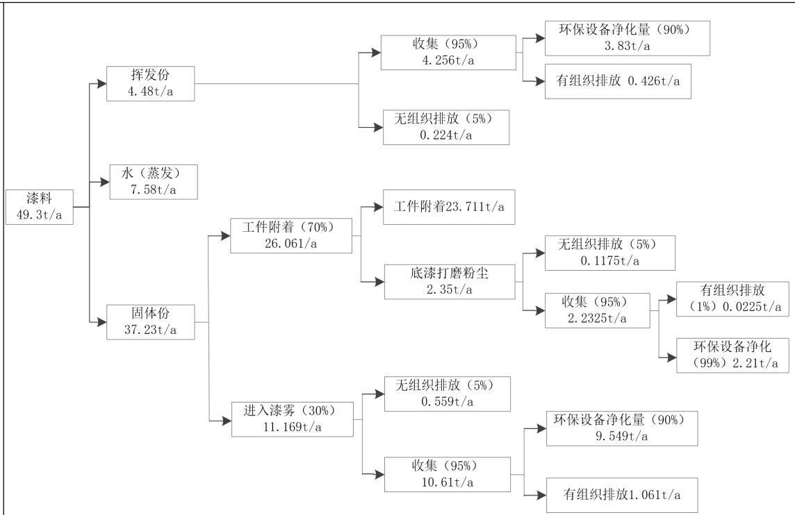
图2-2 本项目水性漆料平衡图 (单位: t/a)
