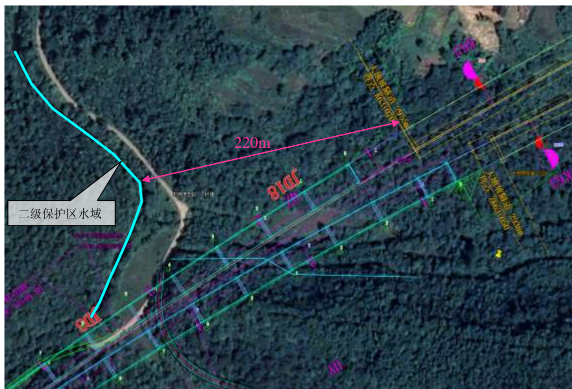
图 5.2.2-1 隧道洞口与长滩河饮用水水源二级保护区水域关系图
