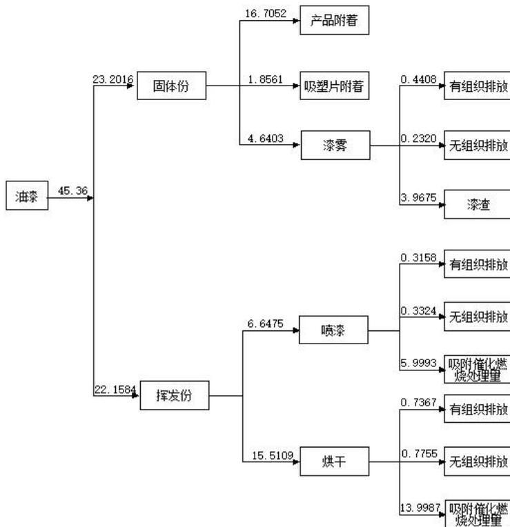
图 3.5-10 油漆物料平衡图 单位: t/a
