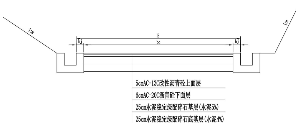
图2-2 本项目路面结构设计图
