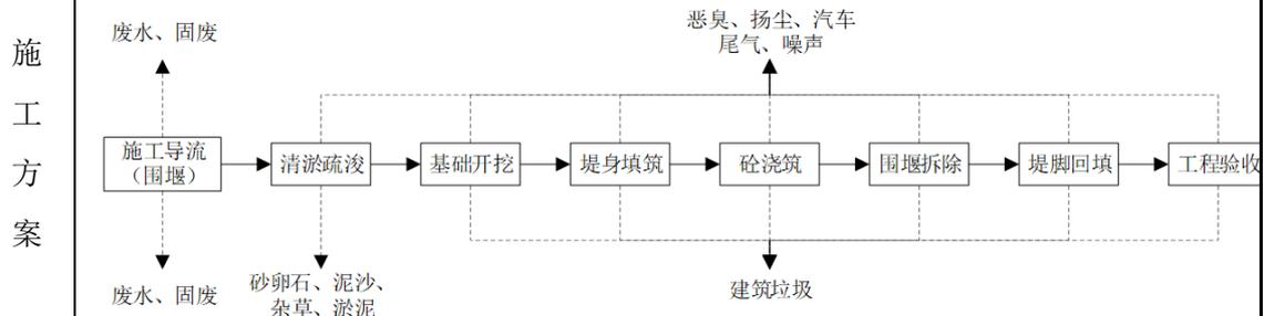
图2-1 项目工艺流程及产污位置图
