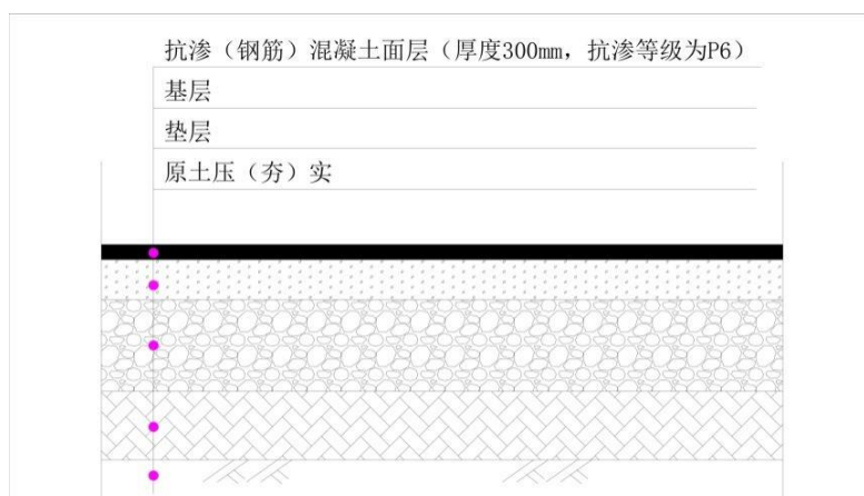
图 3.3-4 一般防渗区防渗结构示意图
