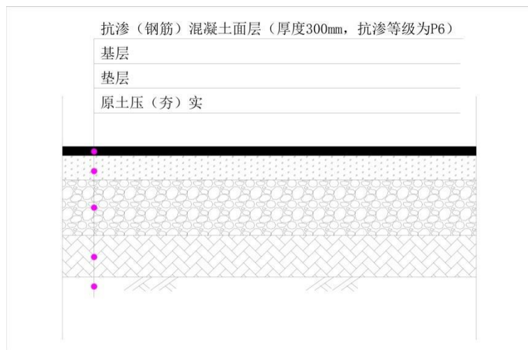
图 11.2-4 一般防渗区防渗结构示意图
