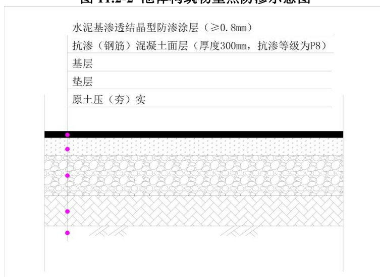
图 11.2-3 地表构筑物重点防渗示意图
