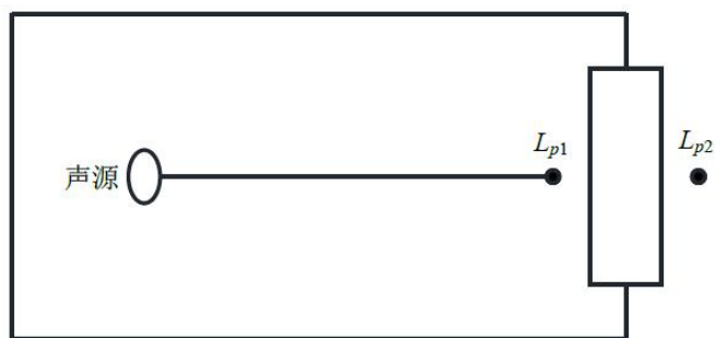
图 7.2-1 室内声源等效为室外声源图例
