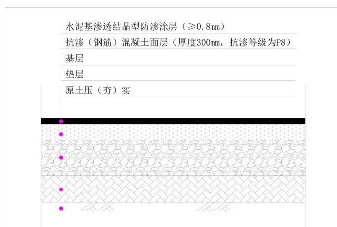
图 3.3-3 地表构筑物重点防渗示意图
