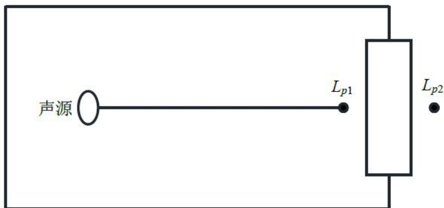
图 7.2-1 室内声源等效为室外声源图例
