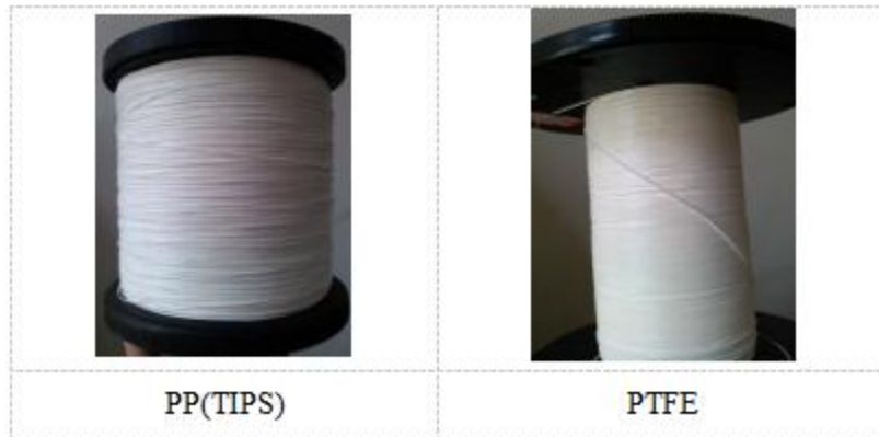
图 2-8 中空纤维疏水微孔膜示意图
