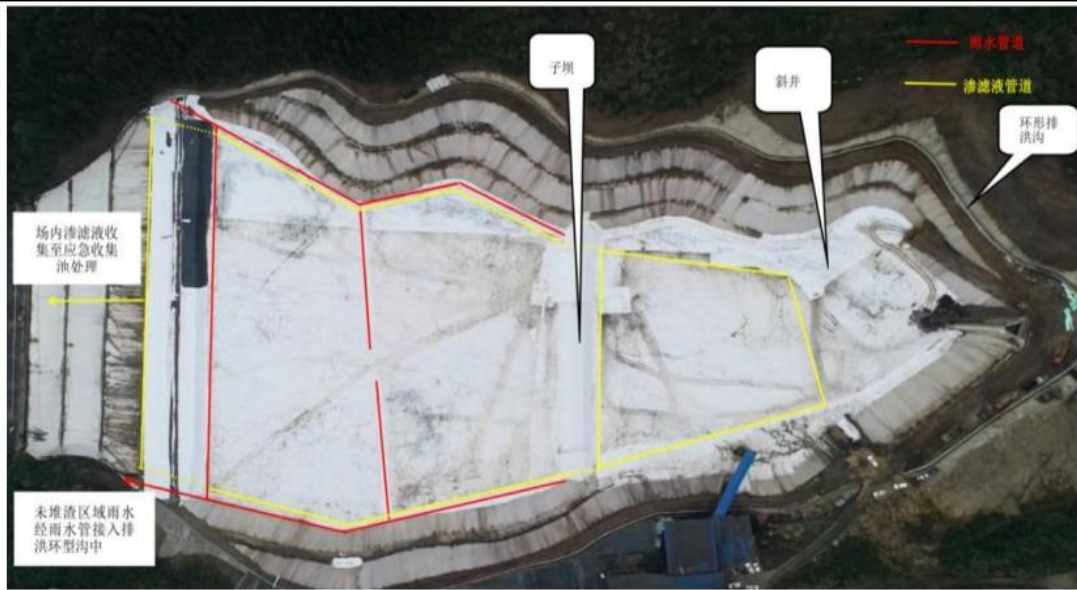
图 2-1 填埋场导排管安装示意图
