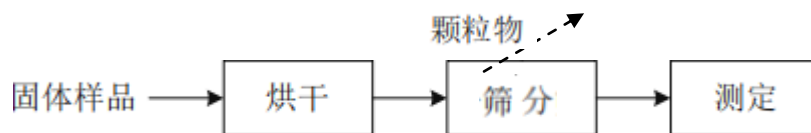
图 2-6 砂石物理性能检测流程
