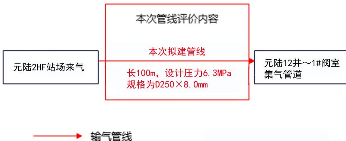
图 3.8-3 内部集输管道运营期工艺流程
