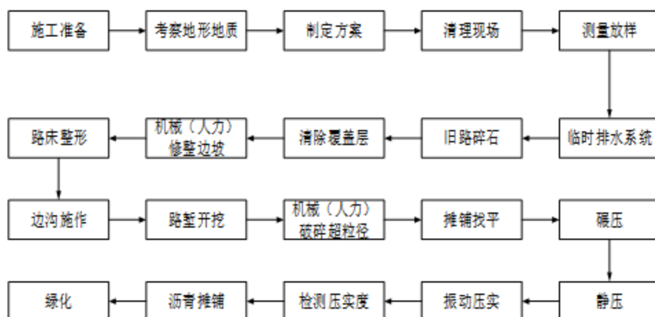
图 4.1-3 改建段道路施工工艺及产污环节流程图
