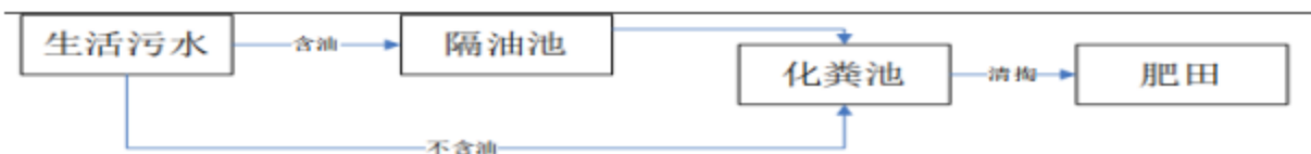
图 7.2-1 生活污水处理流程图
