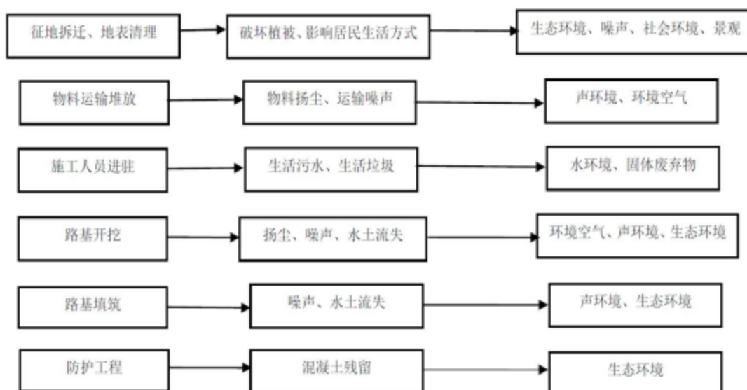
图 4.1-1 路基施工工艺及产污环节流程图
