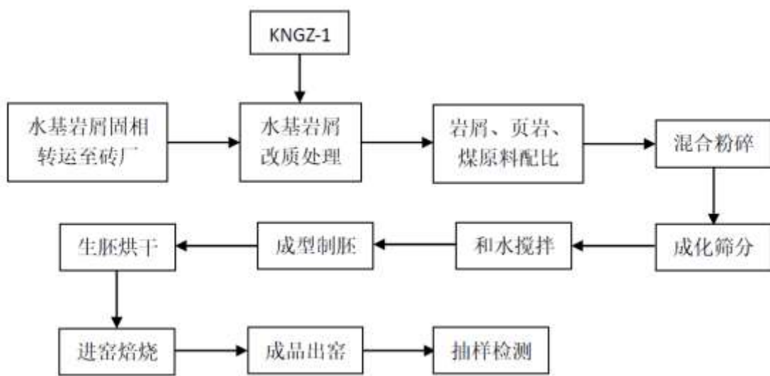
图8.5-2 剑阁县柳沟镇柳林页岩机砖厂工艺流程示意图
