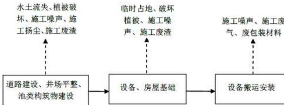
图 4.2-1 钻前工程产污示意图
