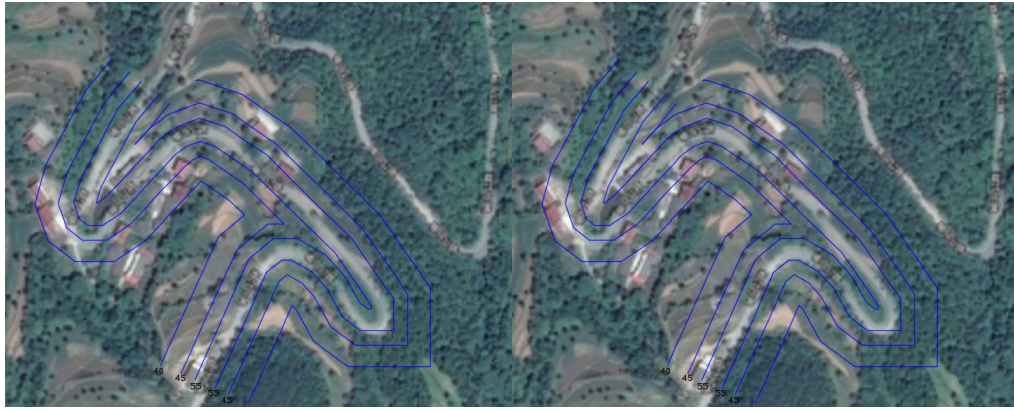
项目近期K3+500~K4+300昼间等声线图 项目近期K3+500~K4+300昼间等声线图
