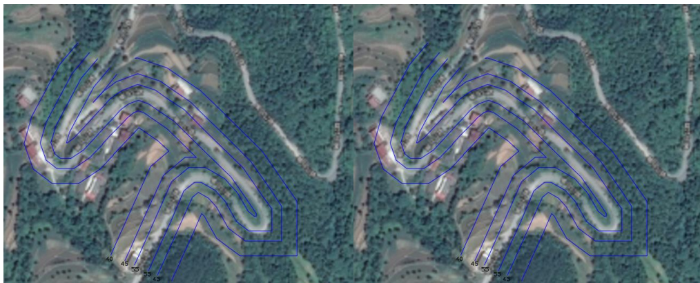
项目远期K3+500~K4+300昼间等声线图 项目远期K3+500~K4+300昼间等声线图
