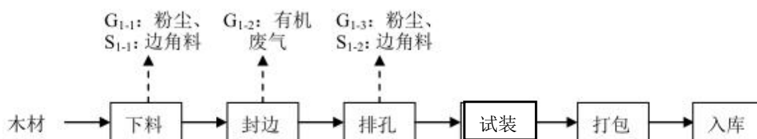
图 5-2 免漆板家居材料生产工艺流程及产污图
