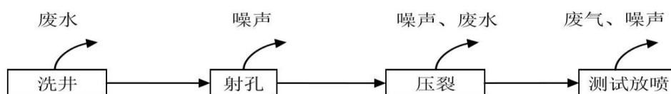
图 5.4-1 完井作业工艺流程及产污节点示意图
